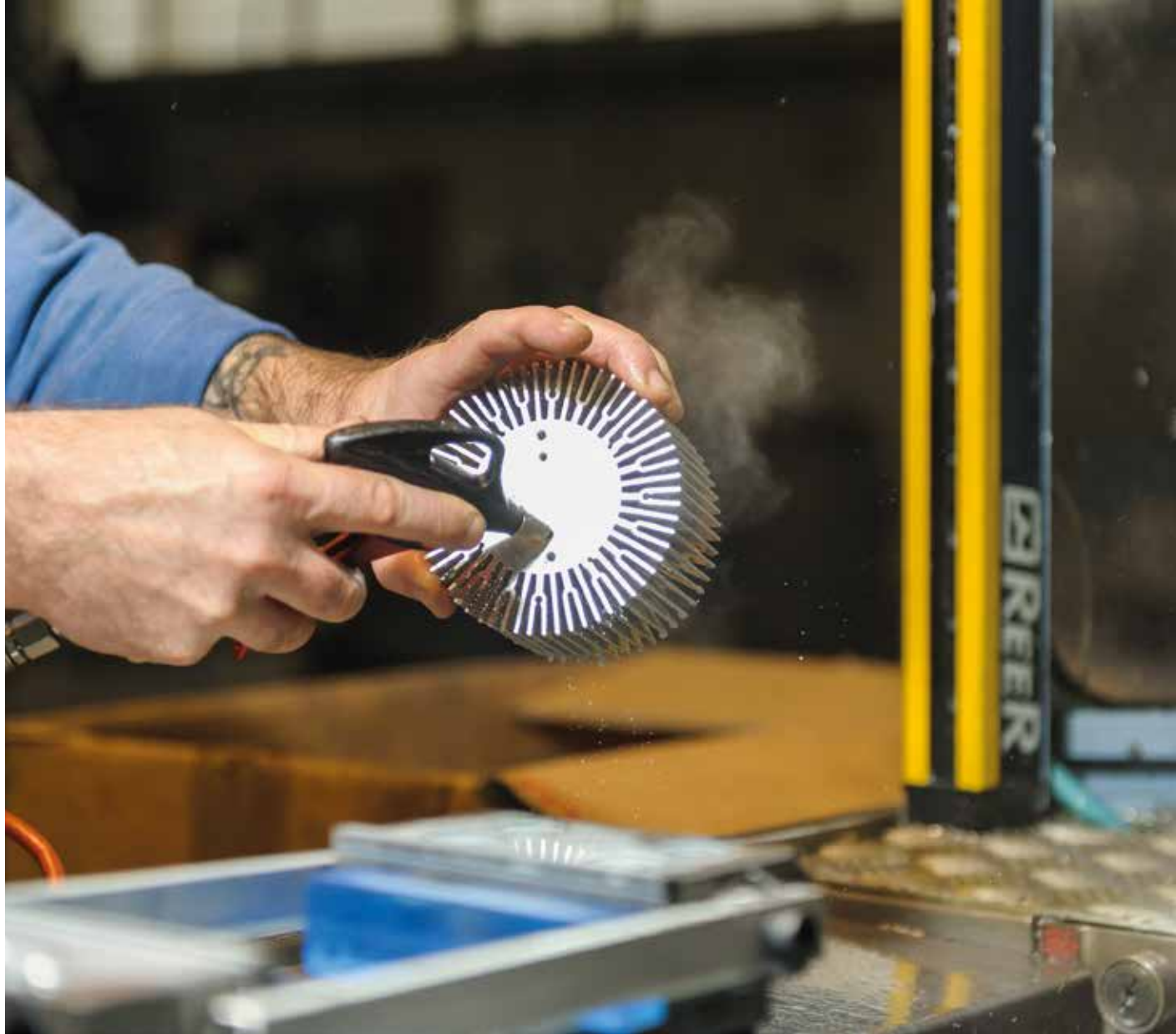
1. Cleaning of the sink after the milling operation (Max) Pulitura del dissipatore dopo l'operazione di fresatura (Max)
