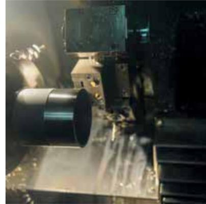
Maschiatura e pulitura del dissipatore (MAX).
